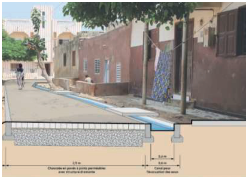
Exemple de caniveau à ciel ouvert permettant l'écoulement des eaux vers l'aval
