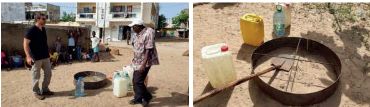
Mise en place de l'anneau légèrement enfoncé dans le sol
