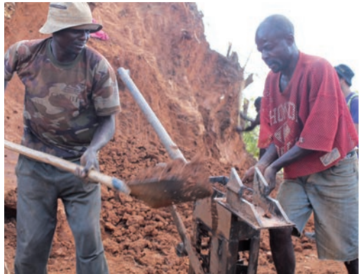
Fabrication de briques pour la construction des dépôts communautaires à partir de termitières situées dans les parcelles, 2015
