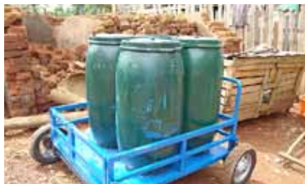
Charrette de transport des boues de vidange.
