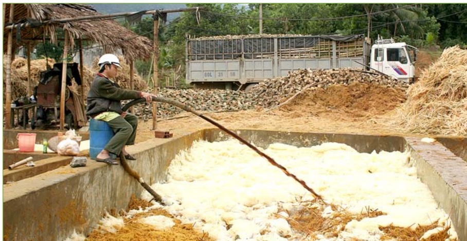
Bassin de traitement des déchets à la soude. Aurélie Vogel, Gret.
