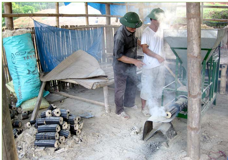
Fabrication de briquettes de sciures de bambou compressées. Patrice Lamballe, Gret.
