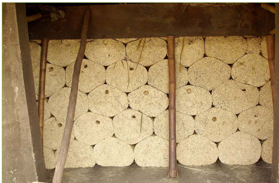
Séchage des baguettes brutes dans un four. Patrice Lamballe, Gret.
