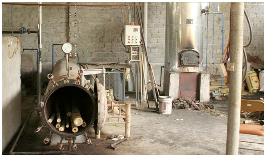
Carbonisateur (à gauche) et sa chaudière (à droite) alimentée par des nœuds de bambou. Patrice Lamballe, Gret.
