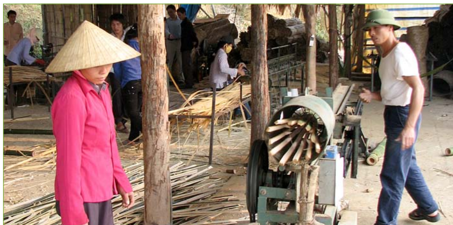
Passage des tiges à la splitteuse. Patrice Lamballe, Gret.
