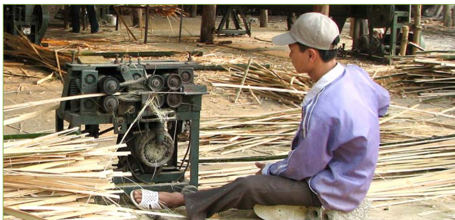
Premier passage des lamelles dans la fendeuse. Patrice Lamballe, Gret.
