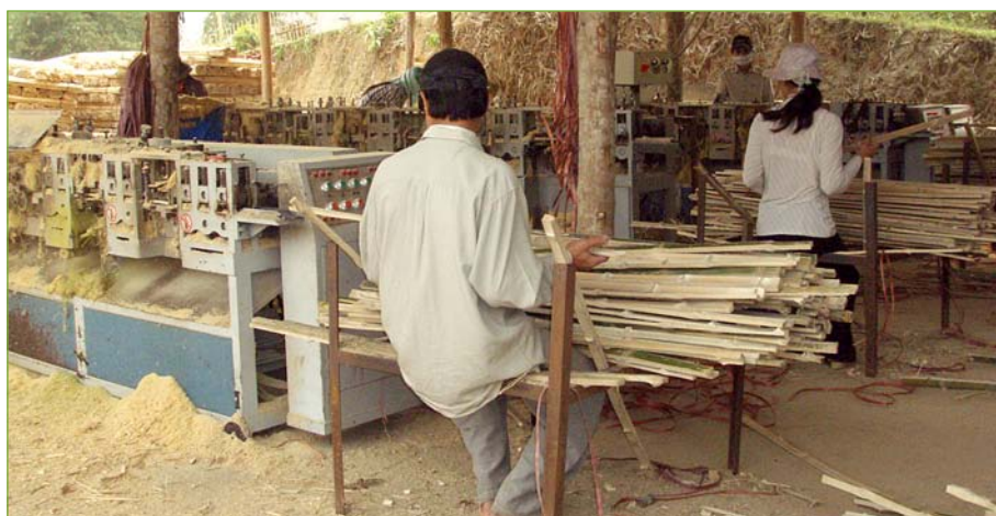
Passage des lamelles brutes à la raboteuse. Patrice Lamballe, Gret.
