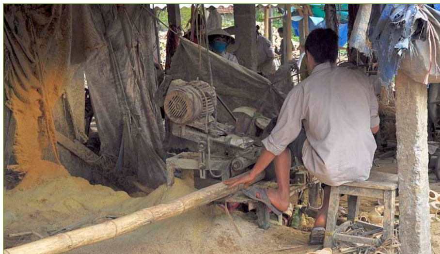
Coupe d'une tige avec une scie circulaire. Patrice Lamballe, Gret.
