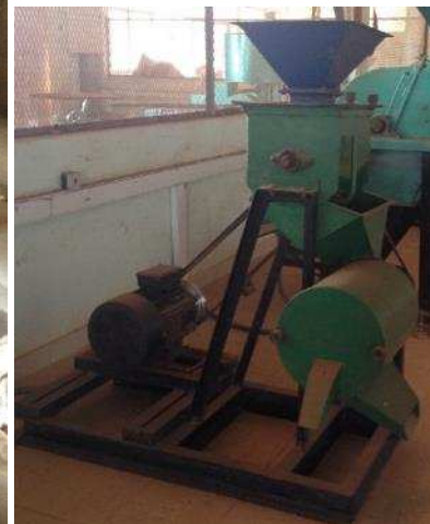
Décortiqueur à disque dans une petite unité de production de brisures et de farine infantile à Ouagadougou et dans un centre de formation professionnelle à Ouahigouya, Burkina Faso, (photo C.Broutin, décembre 2016)
