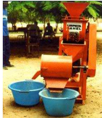
Décortiqueurs à céréales à disques (procédé par voie sèche)
