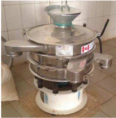
Tamiseur (marque Synmec International, Chine) dans une petite unité de production de brisures et de farine infantile à Ouagadougou, Burkina Faso, (photo C.Broutin, décembre 2016)
