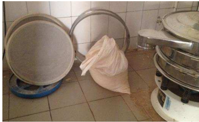
Tamiseur (marque Synmec International, Chine) dans une petite unité de production de brisures et de farine infantile à Ouagadougou, Burkina Faso, (photo C.Broutin, décembre 2016)
