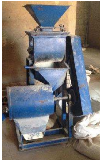
Décortiqueur à disque dans une petite unité de production de brisures et de farine infantile à Ouagadougou et dans un centre de formation professionnelle à Ouahigouya, Burkina Faso, (photo C.Broutin, décembre 2016)
