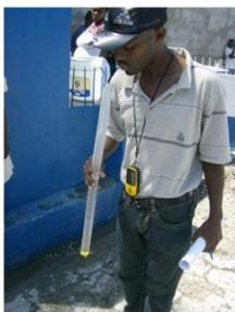
Photo 2 : mesure de la turbidité
