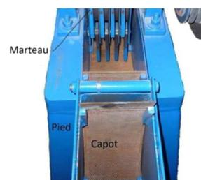
Les perforations de la grille dépendent de la taille des particules recherchée. Leur diamètre peut varier de 0,5 mm à 3 mm, et jusqu'à 5 mm pour les grosses brisures de maïs. Les diamètres supérieurs à 1 mm sont utilisés pour la production de semoule ou de brisures. Les diamètres inférieurs à 1 mm sont utilisés pour les farines de panification (0,5 mm) ou de roulage (0,7-0,8 mm) pour les produits granulés, comme le couscous par exemple.
