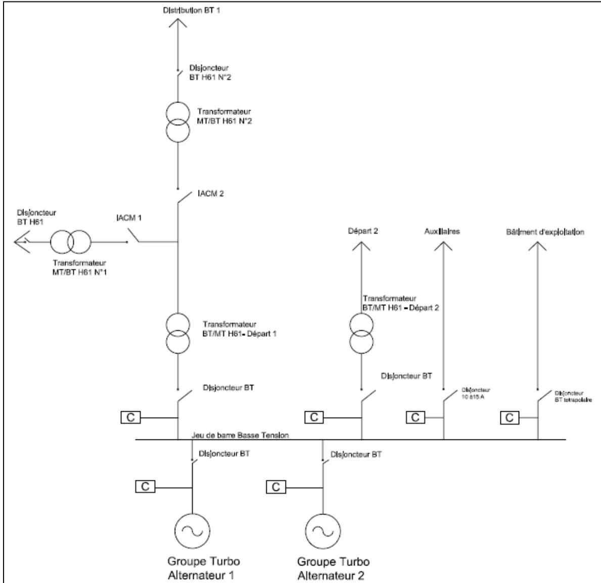
Figure 2 : Schéma unifilaire d'un réseau hydroélectrique rural
