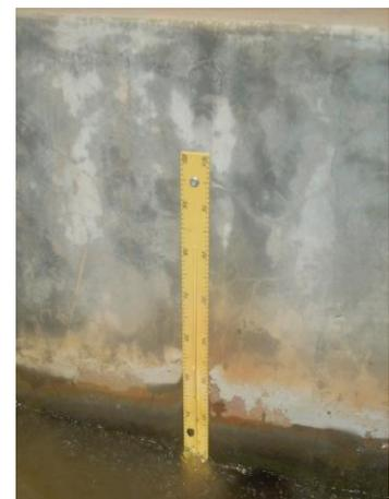
*Mesure de niveau d'eau dans le seuil déversoir*
