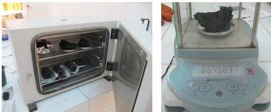
3. Étuve ventilé et balance utilisée à l'Iset pour mesurer l'humidité
