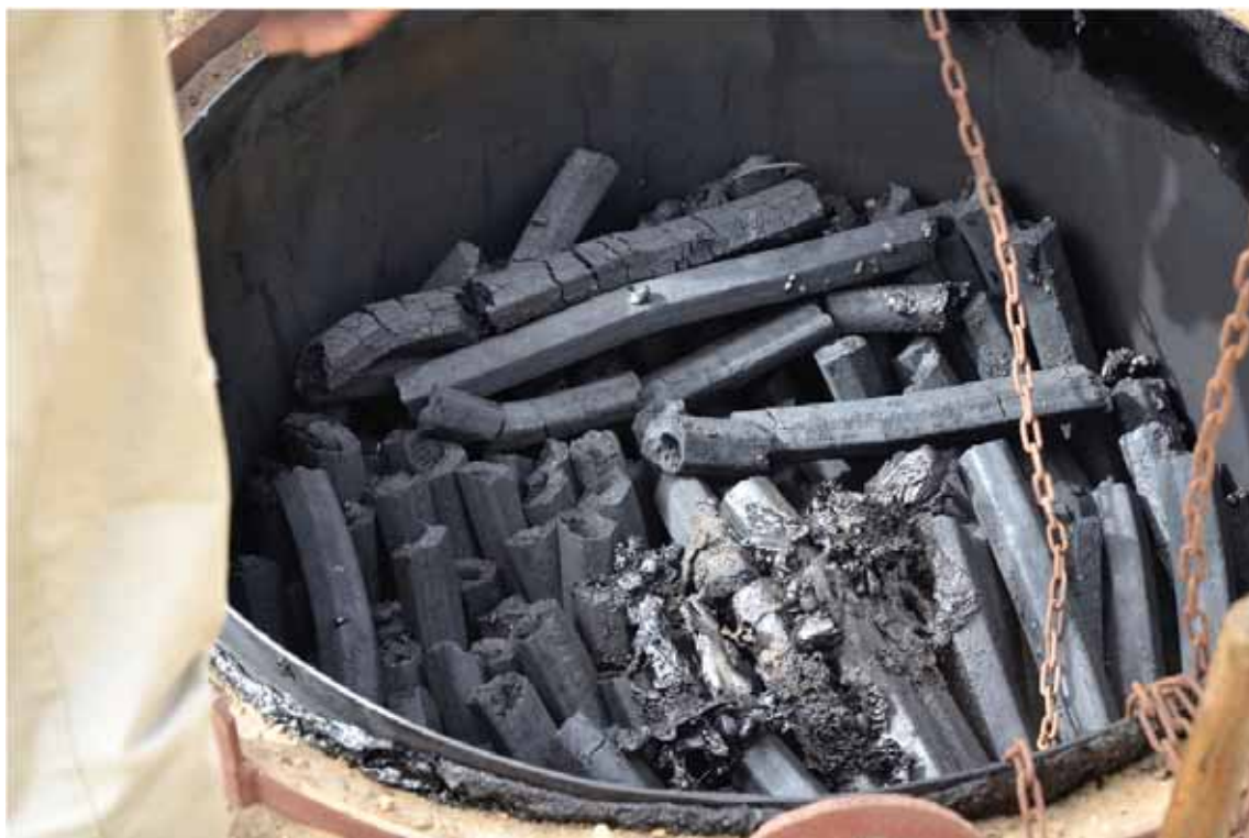
50. Charbon de Typha après ouverture d'un pot
