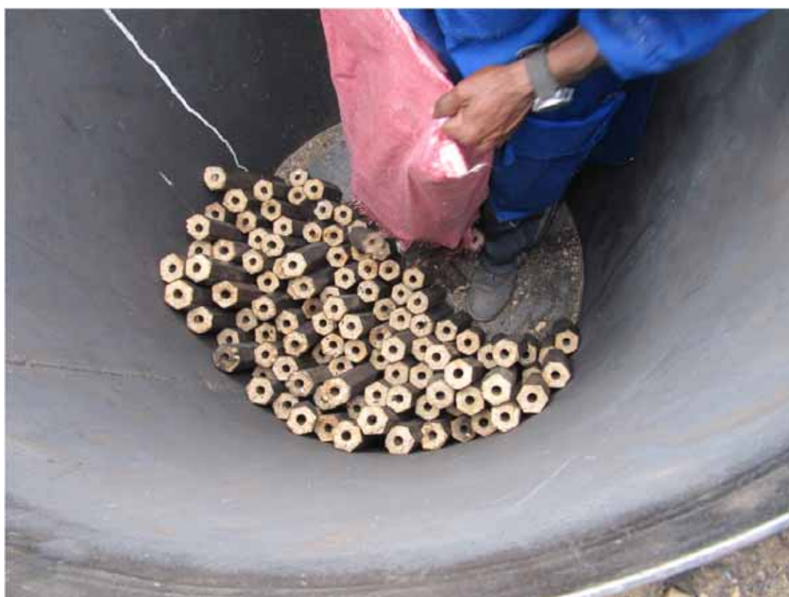
38. Disposition des bquettes à l'intérieur d'un pot
