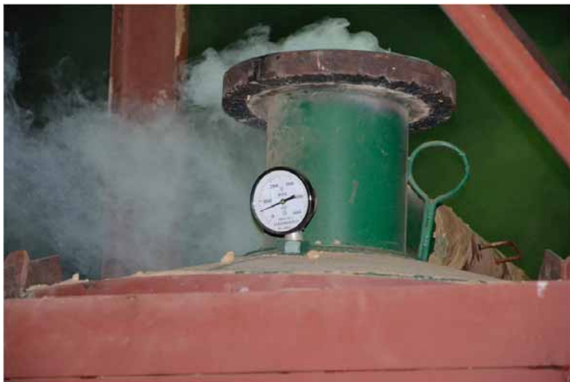
45. Evaporation de l'eau pendant la montée en température
