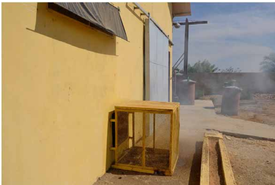
22. Cage de réception extérieure de l'unité en cas d'expulsion de buchettes
