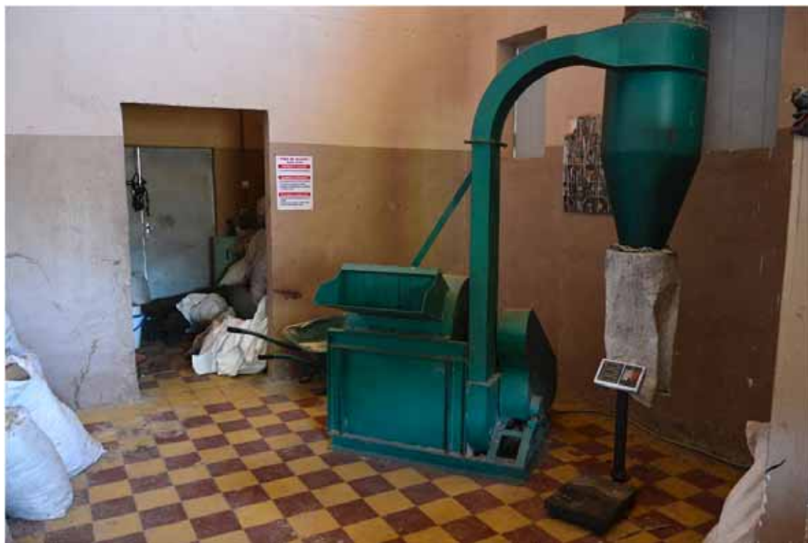
13. Broyeur à marteaux de l'Iset de Rosso
