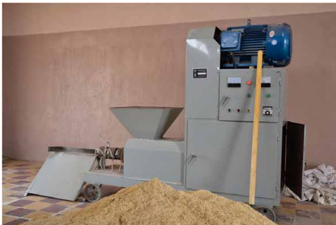
21. Presse à extrusion électrique de l'unité de production semi-industrielle de charbon de Typha de l'Iset
