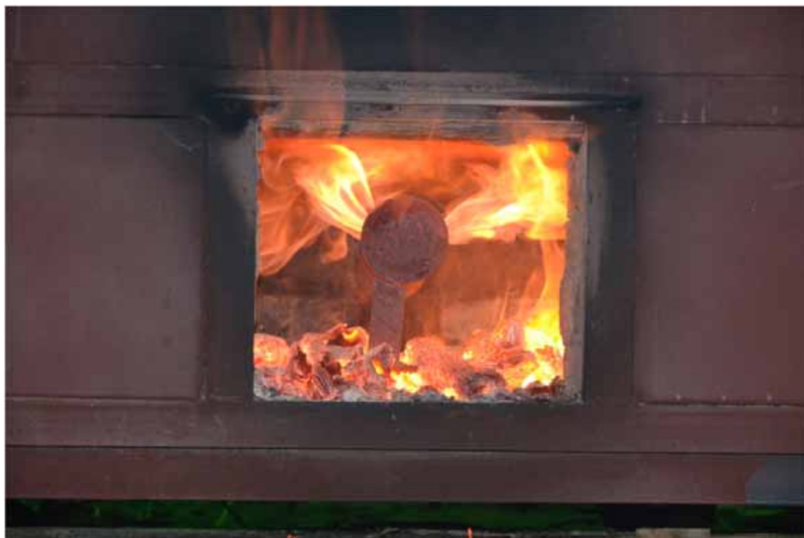
Figure 48 : Combustion des gaz de pyrolyse récupérés, 5h après le démarrage de la carbonisation
