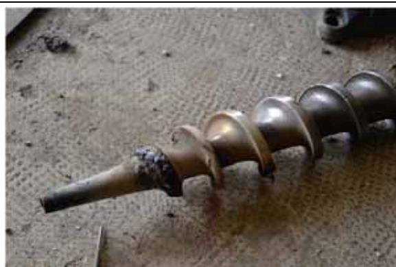
33 : Rechargement par la soudure
