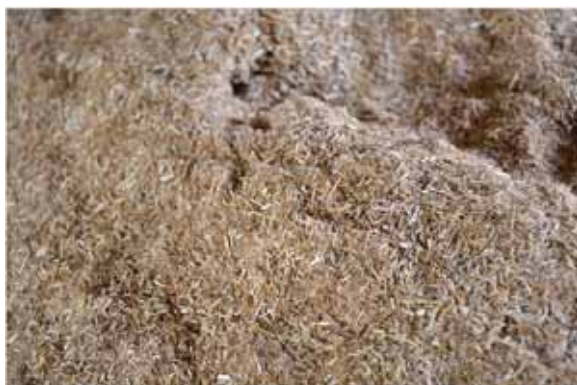
4 : Typha broyé/séché avant l'extrusion
