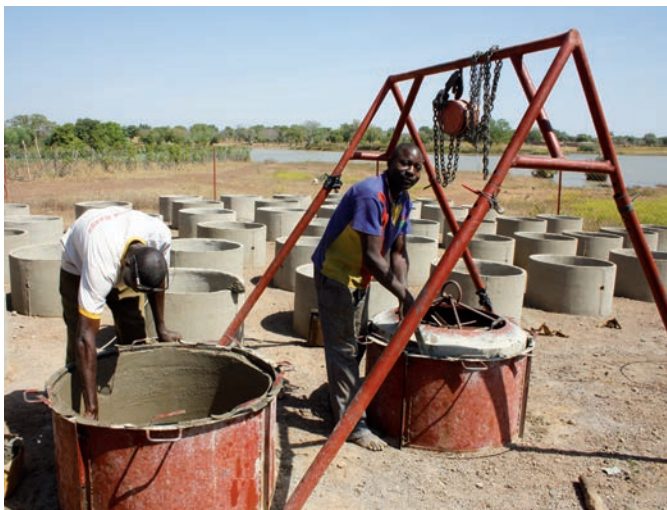
Production de buses sur le site de production de Fara
