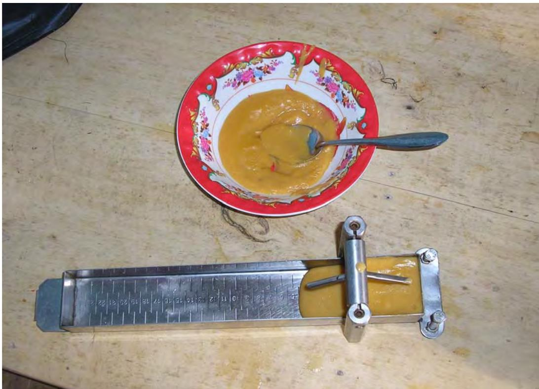
**Photo 8:** Mesure de l'écoulement à l'aide d'un Bostwick
