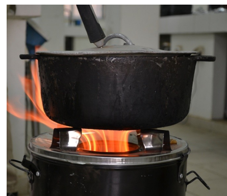
Gazéification du Typha sec dans un Prime Stove
