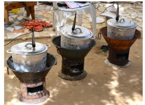
Tests de cuisine comparés : Marmites et thermocouples
