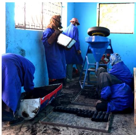
Mélange avec l'argile et briquetage par Rotor Press
