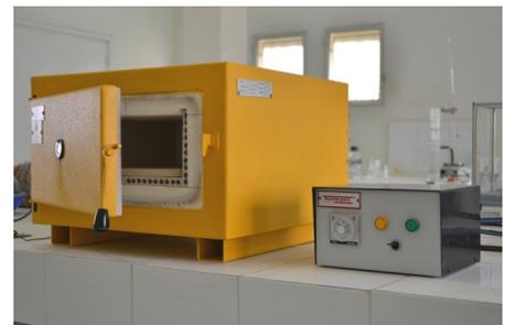
Le four à moufle de l'ISET utilisé au laboratoire pour mesurer le taux de cendre des briquettes produites
