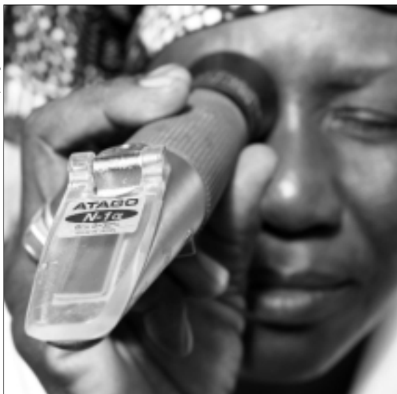
Test qualité, mesure du taux de sucre avec réfractomètre (Shivet Fruits à Mbour, Sénégal).
