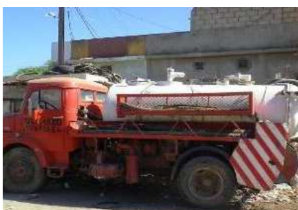
Vidange de fosse septique par camion
