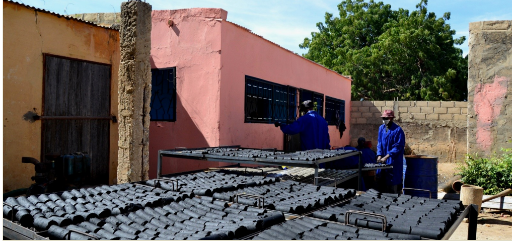
Séchage des briquettes de charbon de Typha après le briquetage - Unité de production du village de Garack dans la commune de Rosso en Mauritanie
